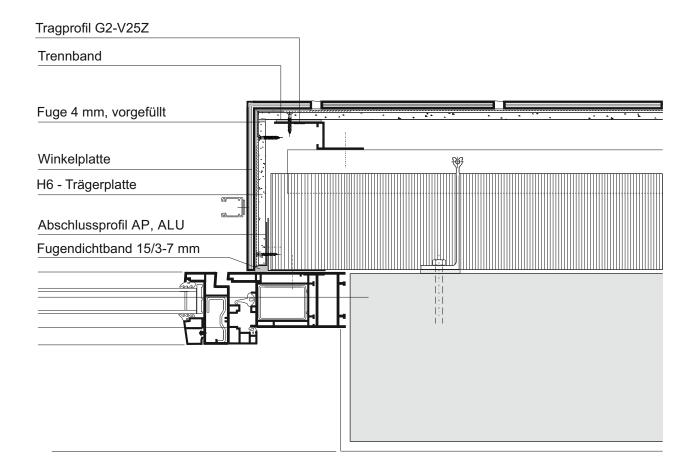
Der Anschluss des Fensterrahmens an den angrenzenden Bauteil muss warmseitig luftdicht ausgebildet werden. ( Norm SIA 331 Fenster )
