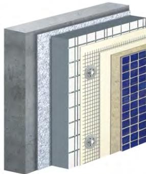
**K-Kerag** bildet die Kombination aus einem klassischen Kompaktsystem und direkt verklebten Mosaik-, Klinker-, sowie Keramik- oder Natursteinplatten. **Stoneface** steht für die Verklebung von individuellen Natursteinbekleidungen auf Kompaktsysteme bis zu einer Gebäudehöhe von 30 m.
